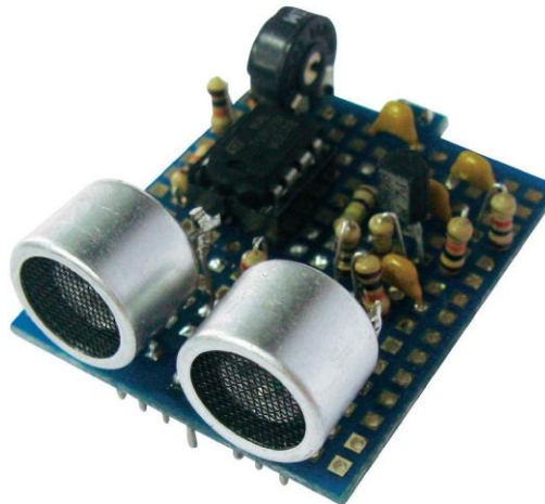
7. ábra: A robotra felszerelt ultrahangos modul
