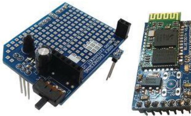
6. ábra: Arexx kiegészítő board és Bluetooth modul
